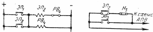
Рис. 1. Схема шунтирования контактов устройства контроля синхронизма АПВ питающей линии.
