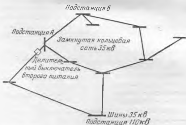
Рис. 2. Схема второго питания к замкнутой кольцевой сети 35 кВ, давшая при осуществлении значительное снижение потерь и повышение напряжения у потребителя.
