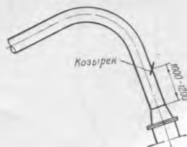
Рис. 5. Установка направляющих козырьков перед горелками.
