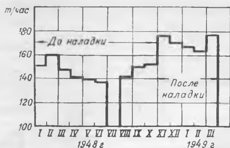
Рис. 6. Нагрузка котла 51СП-220/100 до и после наладки горелок.
