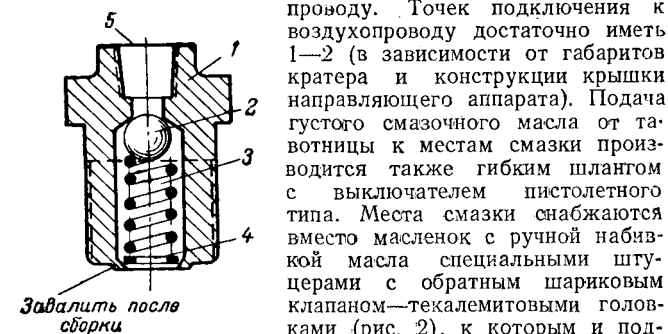
Рис. 2. Штуцер с обратным шариковым затвором.
