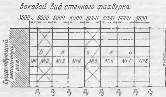
Рис. 1. Монтажная схема металлического каркаса машинного зала.
