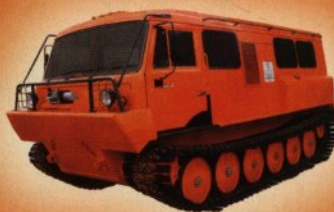
ТТМ-3 «Тайга» г/п до 3000 кг дв. CUMMINS-185 л.с. КПП 6-ст мех. ZF (Германия) 14 чел. (6 спальных мест)
