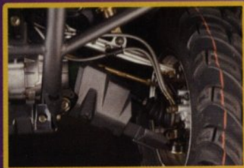
Верхние рычаги подвески из легкосплавного материала
