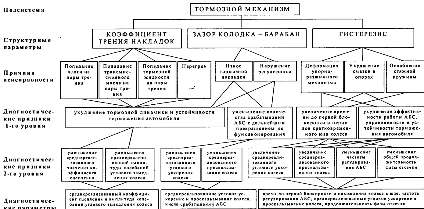
Рис. 3. Структурно-следственная схема для тормозной системы автомобиля с АБС
