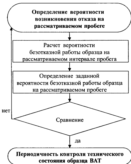
Рис. 3. Последовательность определения периодичности контроля технического состояния армейских АТС
