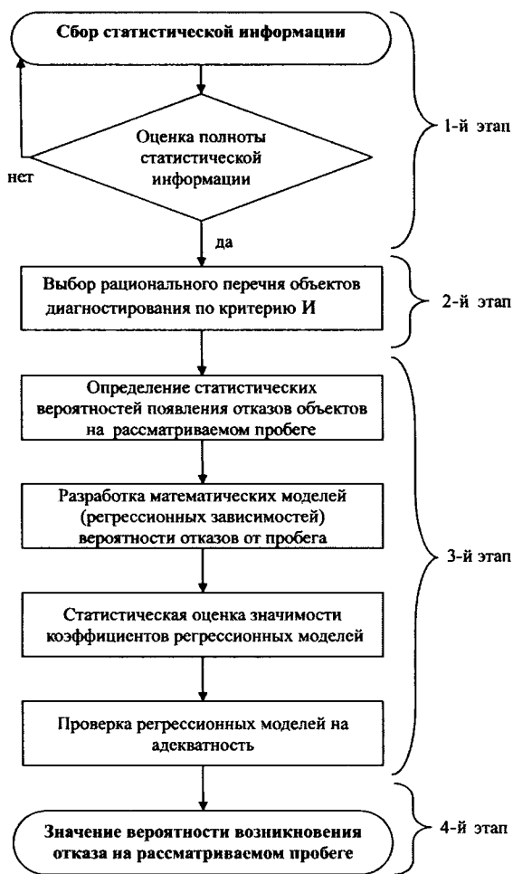
Рис. 1. Последовательность (алгоритм) прогнозирования остаточного ресурса армейских АТС
