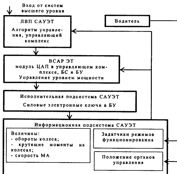
Рис. 3. Функциональная схема САУ на примере САУ электрической трансмиссии физической модели многоосного автомобиля (МА)
