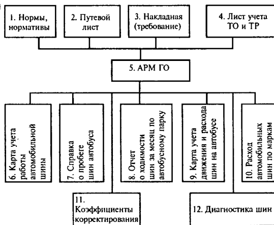
Рис. 1. Информационное обеспечение системы учета работы и адаптивного нормирования ресурса шин
