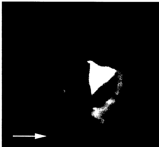
Рис. 1. Работа стандартной свечи зажигания при скорости потока, равной 30 м/с (вид со стороны внешнего электрода)
