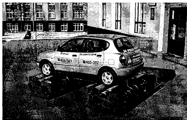
Рис. 1. Общий вид стенда с диагностируемым автомобилем
