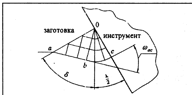
Рис. 4. Сетка скольжения в области вершины профиля накатанной заготовки
