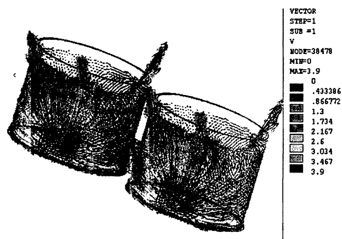
Рис. 2. Распределение скоростей охлаждающей жидкости в полости крайнего цилиндра
