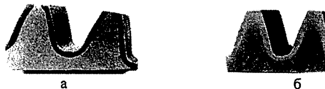
Рис. 1. Расположение закаленного слоя в сечении зуба шестерни
