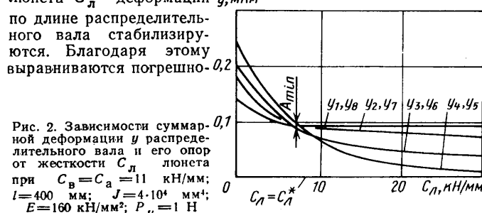
Рис. 2. Зависимости суммарной деформации y распределительного вала и его опор от жесткости C_l люнета
