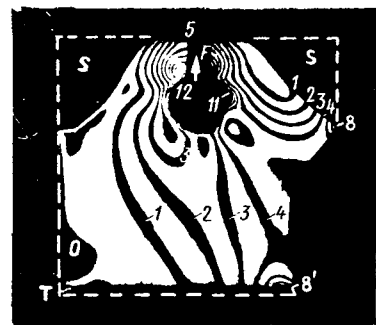
Рис. 3. Картина полос в модели ребра вала сошки
