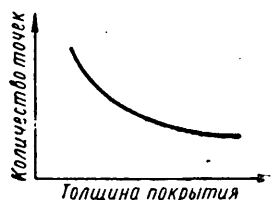
Рис. 2. Зависимость стойкости электродов от толщины цинкового покрытия
