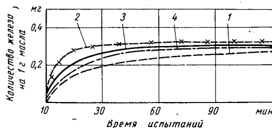
Влияние присадки к маслу на интенсивность и качество приработки деталей двигателей:
