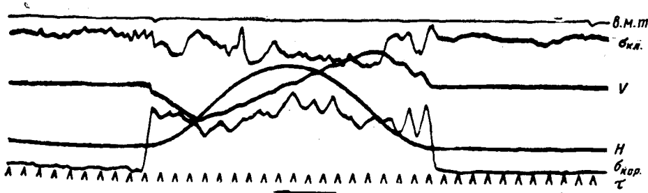
Рис. 7. Осциллограмма подъемов, скоростей клапана и напряжений в стержне клапана и в коромысле.
