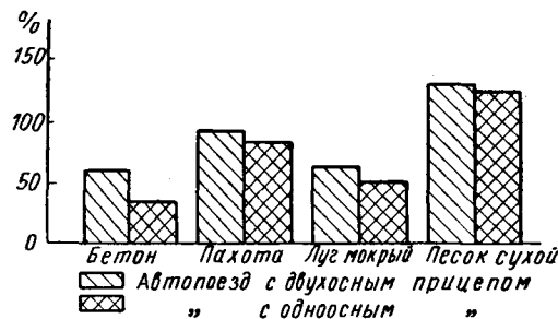
Рис. 6. Относительный рост тягового усилия (в %) при включении ведущих осей прицепов.
