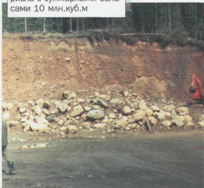
Добыча валунно-песчаного материала на Октябрьском месторождении (Вытегорский район), сырье которого в 2000 - 2002 годах направлялось на строительство автодороги Вытегра - Медвежьегорск.
