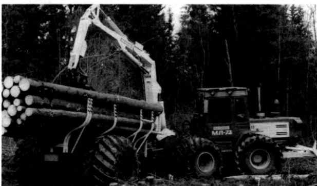
Сортиментовоз МЛ-72-05 на базе валочно-сучкорезно-раскряжевой машины
