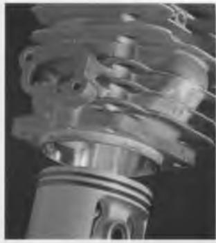
Легкий поршень и тщательно подогнанные, охлаждающие фланцы цилиндра делают наши пилы прочными и надежными. Точнейшая технология обеспечивает незначительное, ниже обычной нормы, трение между подвижными частями двигателя, увеличивая тем самым срок службы пилы.
