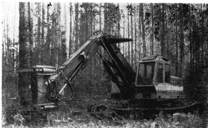
Новая валочно-пакетирующая машина легкого типа ЛП-60 «Абакан».
