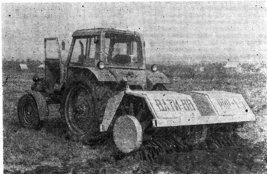
Опытный машинно-тракторный агрегат МТЗ-80 с роторным рыхлителем почвы РПР-1,5
