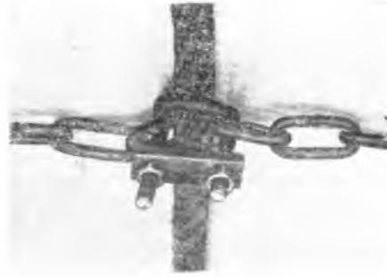
Рис. 2. Соединение каната с цепью
