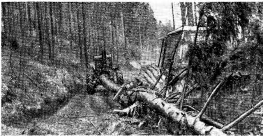
Рис. 3. Протаскивание дерева трактором через сучкорезное устройство
