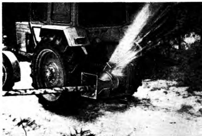
**Рис. 2. Навесная спирально-винтовая рубильная машина (труба выдува щепы снята)**
