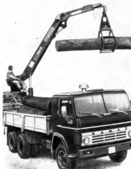
Гидравлический кран типа KCR-8014 Подъемное усилие 80 кДж Максимальный вылет стрелы 6300 мм Угол поворота 390°
