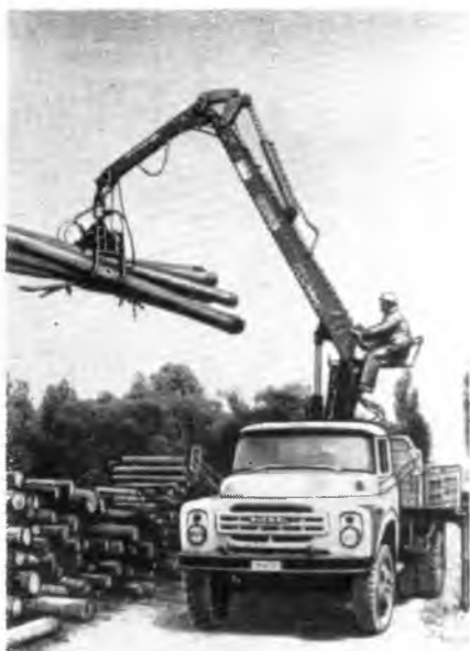
Гидравлический кран типа KCR-5010 Подъемное усилие 50 кДж Максимальный вылет стрелы 6200 мм Угол поворота 410°
