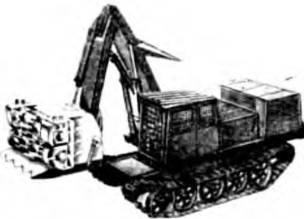
Рис. 3. Самоходный подборщик-измельчитель на базе вальечно-накетирующей машины ЛП-19
