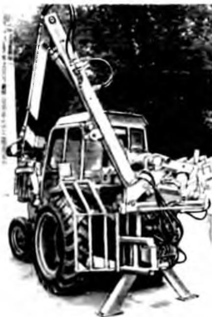
Рис. 1. Сучкорезная машина типа EA-20Z-2 для обработки деревьев диаметром до 20 см
