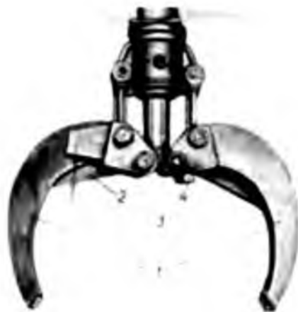
Рис. 1. Общий вид захвата с перерезающими ножами на тракторе ТБ-1
