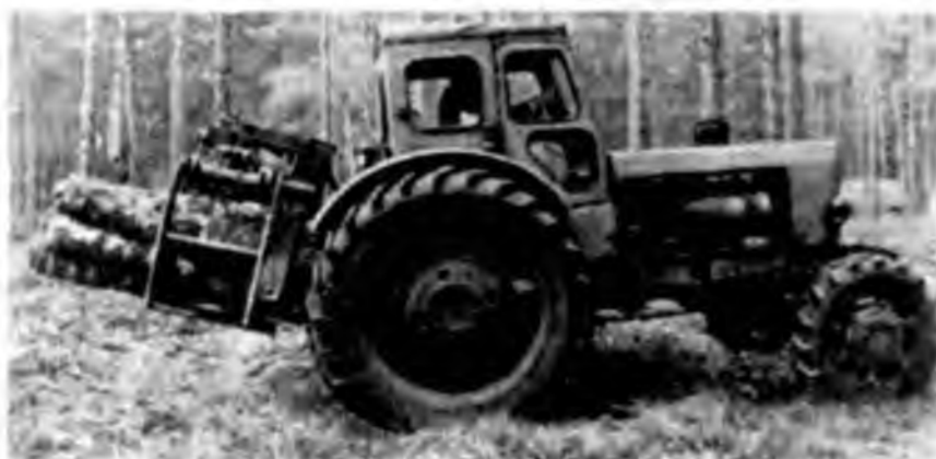
Рис. 3. Трактор Т-40А, оснащенный грейфером для подвозки короткомерных сортиментов на промежуточных рубках
