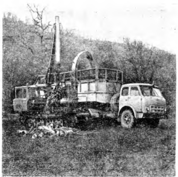
Выработка щепы на лесосеке в Крестецком опытном леспромхозе ЦНИИМЭ
