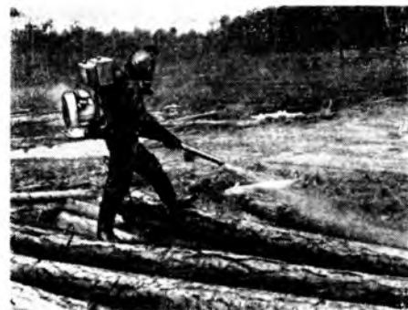
Нанесение ядохимиката на поверхность хлыстов опрыскивателем ОМР-2
