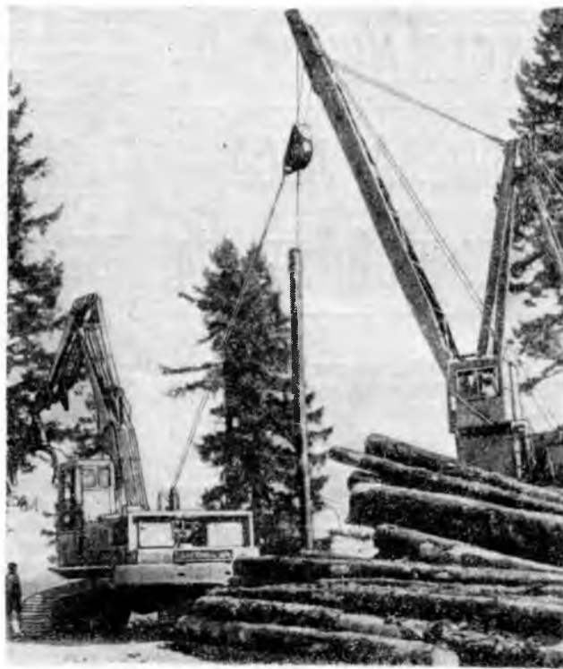
Канатная установка Washington 118 для трелевки древесины на расстояние до 360 м, действующая в комплекте с гидравлическим погрузчиком бревен Caterpillar-235.
