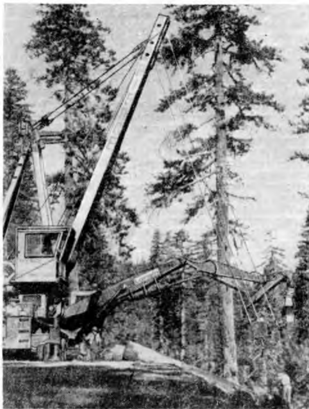
Канатная установка Pierce PSY-200, совмещенная с погрузочной стрелой Logain 60. Стрела смонтирована сбоку ко- лесной базы
