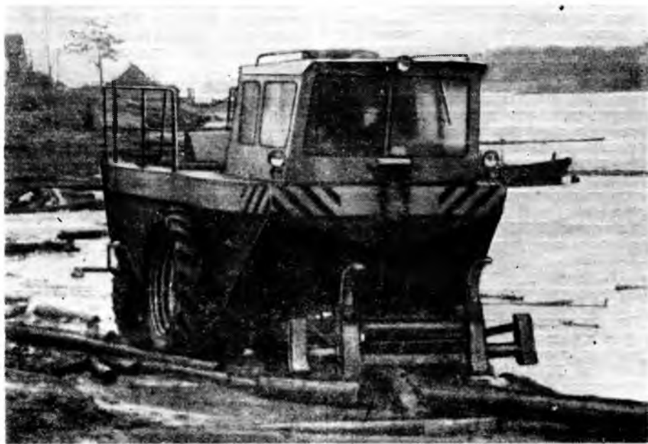
Рис. 2. Скатка обсохшей древесины трактором на р. Оять
