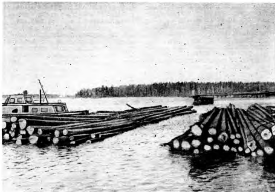
Рис. 2. Постановка в секцию пучка катером ПС-5
