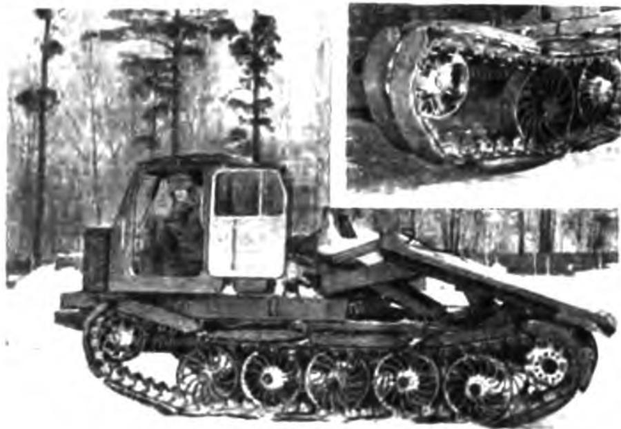
Первый лесной трелевочный трактор ТТ-4 на эластичных гусеничных движителях конструкции УЛТИ (вверху эластичный гусеничный движитель показан более крупным планом)
