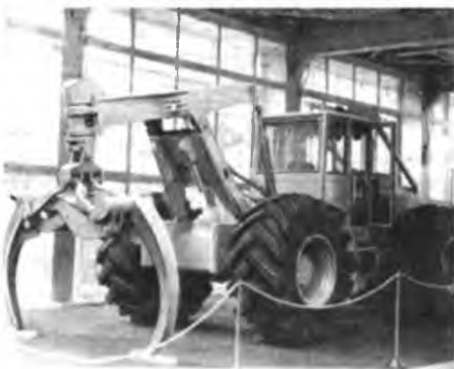
Рис. 8. Трелевочный трактор Тимберджек 520 с клещевым захватом (Канада)
