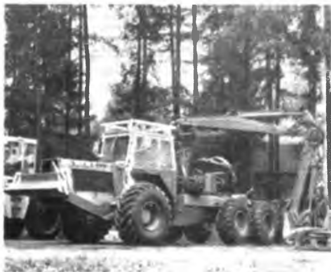
Рис. 1. Валочно-трелевочная машина LPS-120 (совместная разработка чехословацких и советских специалистов)
