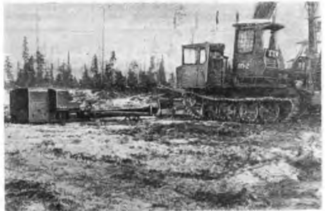
Рис. 4 Предпусковая подготовка лесосечных машин агрегатом ЛВ-115
