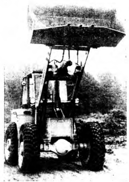
Рис. 2. Колесный погрузчик «Дутра» (Венгрия) с ковшом-лопатой емкостью 1,3 м 3
