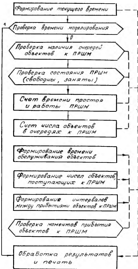
Рис. 2. Структурная схема моделирующего алгоритма ПРШМ и трех входящих потоков обслуживаемых объектов
