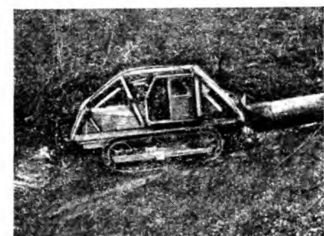
Рис. 3. Трелевка трактором Т-100М с навесным оборудованием
