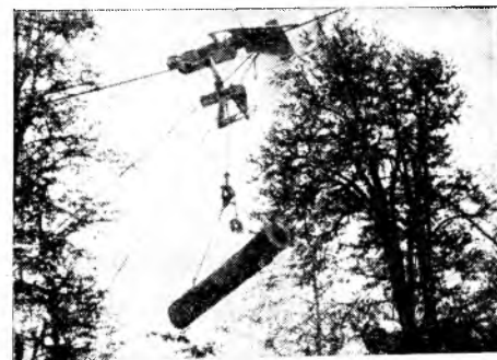
Рис. 1. Воздушно-трелевочная установка с упрощенной кареткой и проходным стопором
