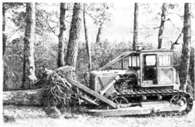
Рис. 4. Докорчевка захватами поваленного дерева
