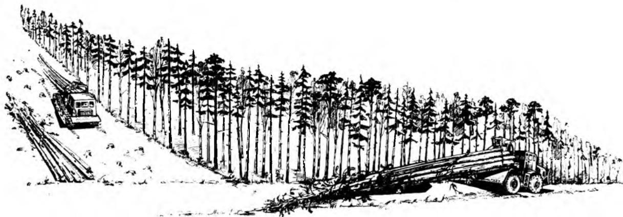
Рис. 4. Технологическая схема разработки лесосеки с применением ВТМ-4 и колесных тягачей на прямой вывозке
