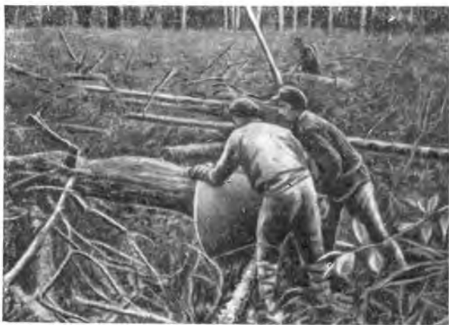
Одевание конуса на хлыст при трелевке лебедкой
