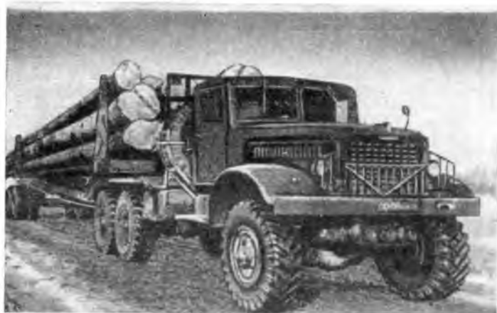
Вывозка хлыстов на автопоезде (КрАЗ-214)
