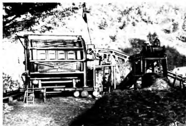
Рис. 2. Передвижная установка для производства щепы
