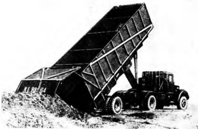
Рис. 2. Разгрузка щеповоза на буферном складе щепы
