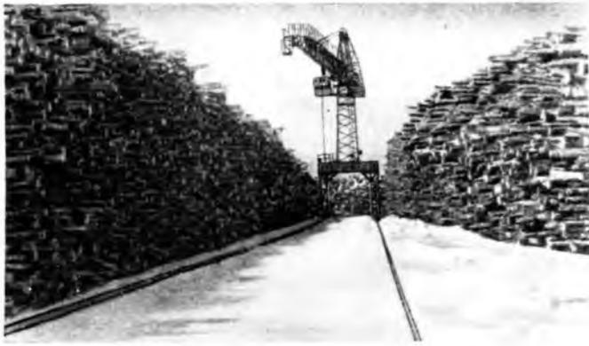
Рис. 2. Укладка древесины в беспрокладочные штабеля
