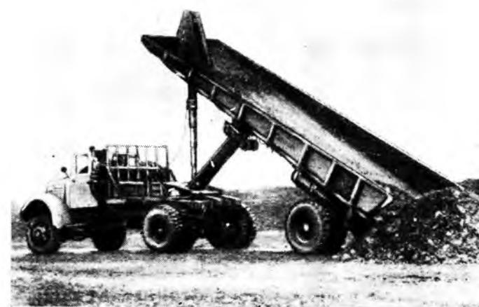
Рис. 3. Полуприцеп ЛТ-7 со снятыми бортовыми надставками
