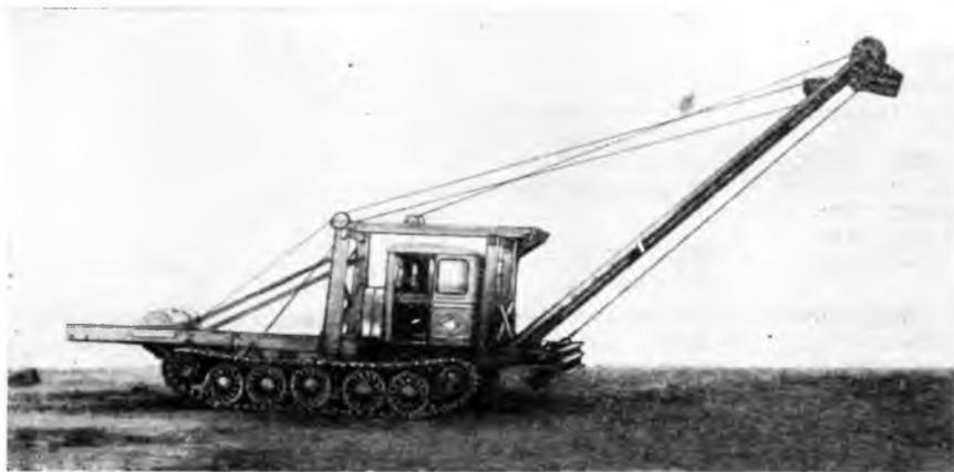
Крановая установка на тракторе ТДТ-75
