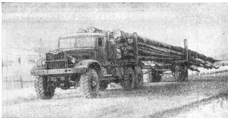
Рис. 2. Общий вид груженого автопоезда КраЗ-214ЛК2.
