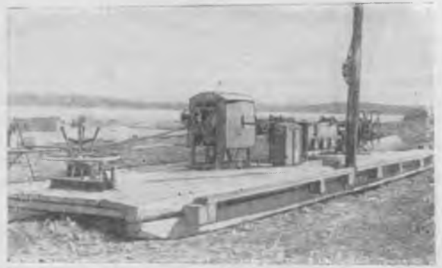
Рис. 7. Поточная линия для ухода за стальными канатами
