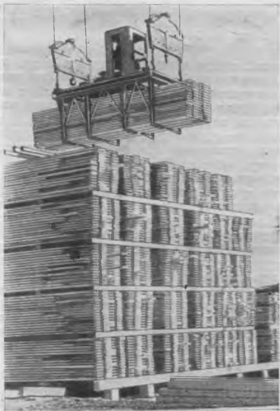
Рис. 2. Мостокабельный кран устанавливает пакет пиломатериалов в штабель для сушки
